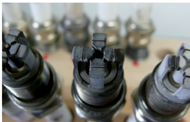
Свечи зажигания — GE Jenbacher J 312 V12
