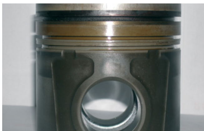
Поршень с кольцевыми канавками — MWM TCG 2016 V12
