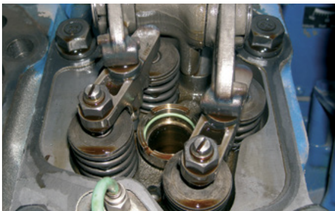
Клапанный механизм — MWM TCG 2016 V12
